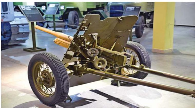
*45-мм противотанковая пушка образца 1937 г.*
